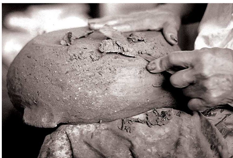
Figura 18 - Modelagem manual da panela de barro
