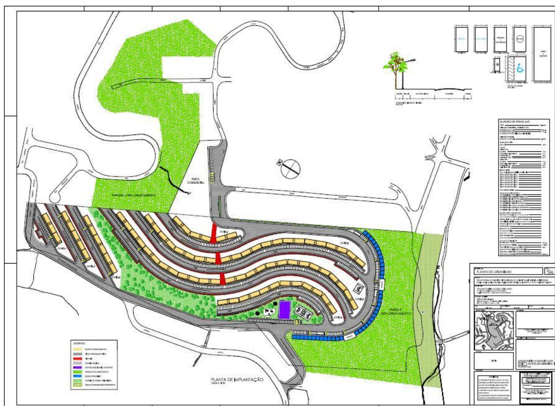
Figura 18 – Projeto originário (inviável e revisado) do Jardim São Camilo, que previa a remoção total e a construção de 600 apartamentos na própria área do assentamento precário, completamente desocupada
