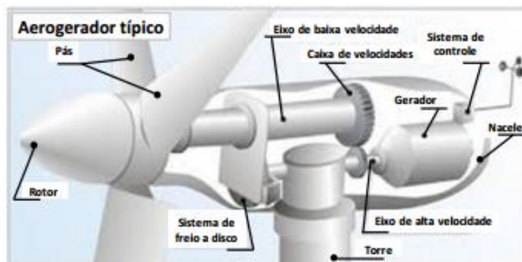
Figura 7 - Componentes do Aerogerador - fonte: MME, 2016
